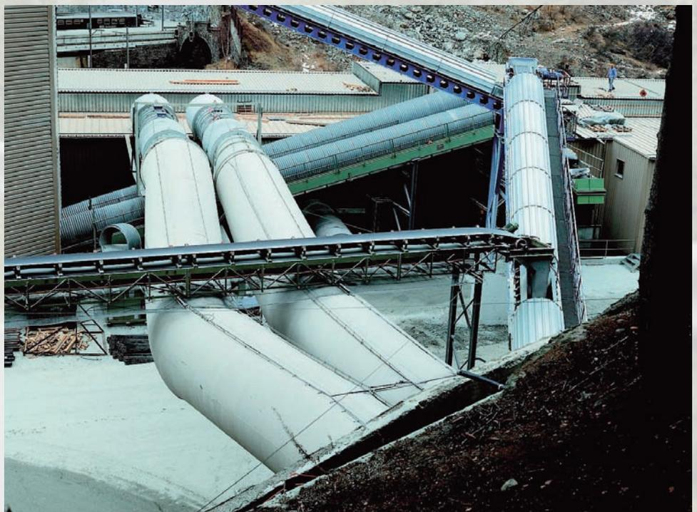
*La tubería está fabricada a partir de un material flexible que es retardante al fuego, resistente a los agentes químicos y libre de mantenimiento.*
